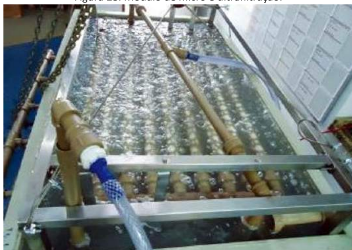
Figura 28. Módulo de micro e ultrafiltração.
